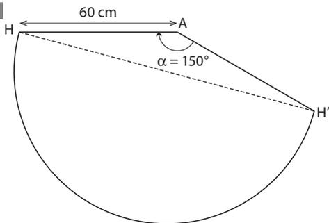
Dans le patron ci-dessus du cône, la longueur de  $\widehat{H'H}$  est le périmètre de la base, c'est-à-dire  $50\pi$  puisque la base circulaire a pour diamètre 50 cm.
